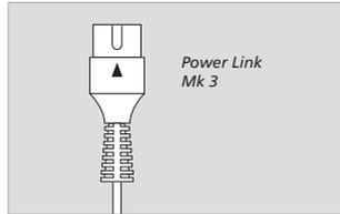
**Cables Power Link:** Los cables deben ser del tipo que ostenta una marca triangular en el conector. No use cables Power Link antiguos; generan ruido y no proporcionan una calidad de sonido óptima.
