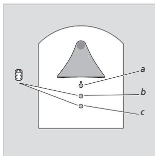
Los orificios de montaje (b y c) están bloqueados con dos pequeños tornillos y, para poder utilizarlos, deberá retirar los tornillos.
