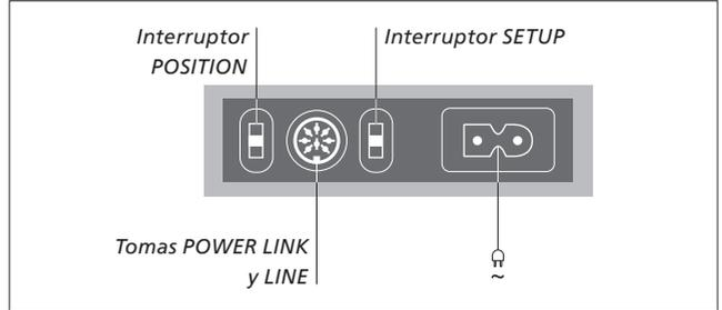
El panel de conexiones está situado en la parte inferior del altavoz.
